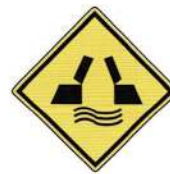
2-33 สะพานเปิดได้
